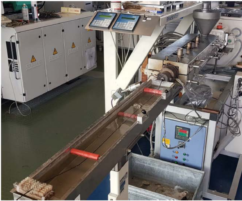
Compounding der Rezepturen auf Doppelschneckenextruder
